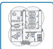
La calidad de la conexión se mantendrá cuando te desplaces del área de una antena repetidora a otra, por lo que no tendrás que abandonar la conversación y podrás continuar con aquella llamada tan importante.
